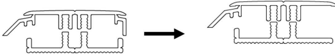
Sägen Sie das Profil zunächst auf die korrekte Länge zu. Trennen Sie mithilfe des Tellermessers Komponente Y ab, um ein Anpassungsprofil/Reduzierprofil zu erhalten. Pressen Sie das Profil zum Verlegen sachte von einer Seite der Schiene zur anderen ein. Drücken Sie es anschließend auf den Boden.
