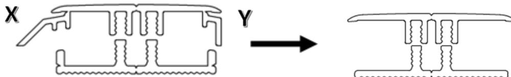
Sägen Sie das Profil zunächst auf die korrekte Länge zu. Trennen Sie mithilfe des Tellermessers Komponente X und Komponente Y ab, um ein Dehnungsprofil/T-Profil zu erhalten. Hinweis: Kürzen Sie für ein vereinfachtes Zuschneiden zunächst beide Längen, bevor Sie die 2 überschüssigen Komponenten entfernen. Pressen Sie das Profil zum Verlegen sachte von einer Seite der Schiene zur anderen ein. Drücken Sie es anschließend auf den Boden.
