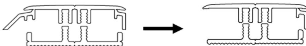
Sägen Sie das Profil zunächst auf die korrekte Länge zu. Trennen Sie mithilfe des Tellermessers Komponente X ab, um ein Übergangsprofil zu erhalten. Pressen Sie das Profil zum Verlegen sachte von einer Seite der Schiene zur anderen ein. Drücken Sie es anschließend auf den Boden.
