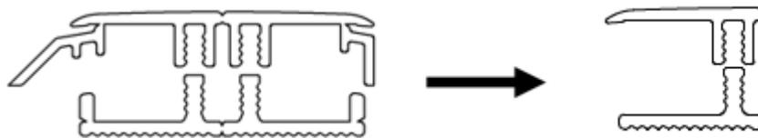
Sägen Sie das Profil zunächst auf die korrekte Länge zu. Trennen Sie mithilfe des Tellermessers Komponente X und Komponente Y ab, um ein Dehnungsprofil zu erhalten. Verwenden Sie anschließend Klinge B, um das Profil zu halbieren. Pressen Sie das Profil zum Verlegen sachte von einer Seite der Schiene zur anderen ein. Drücken Sie es anschließend auf den Boden.
